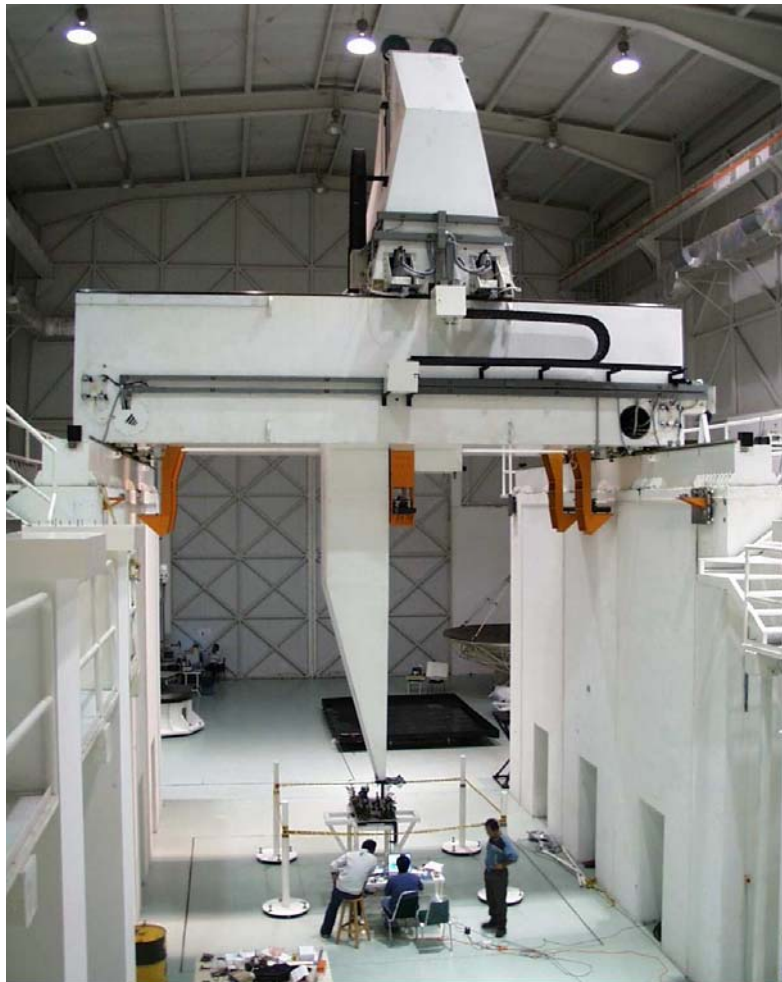
FIGURA 6.10. La máquina de medición por coordenadas en el Instituto Nacional de Astrofísica, Óptica y Electrónica.
