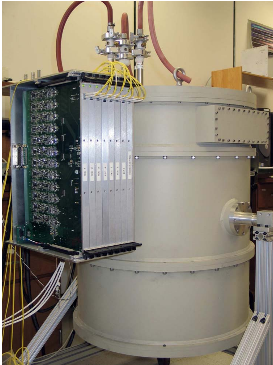
FIGURA 1.14. El criostato y la electrónica de lectura de la cámara de emisión térmica AZTEC en el Cryogenic Device Laboratory de la University of Massachusetts Amherst.
