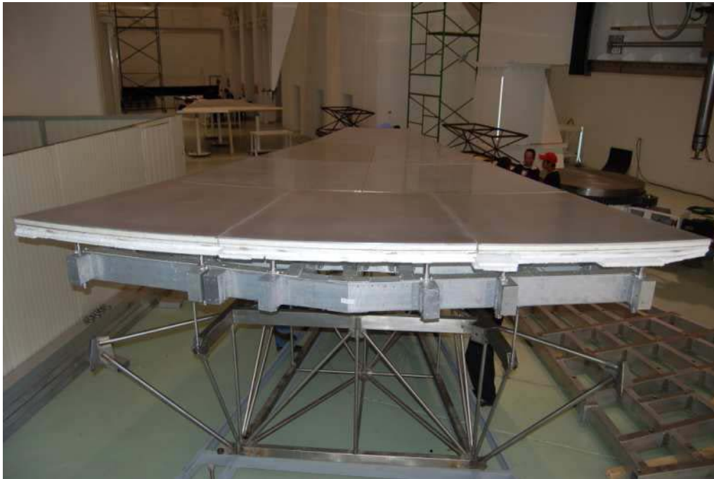
FIGURA 6.2. Prototipo de un segmento de níquel del Gran Telescopio Milimétrico. En su mayoría, los paneles están formados por ocho subpaneles.
